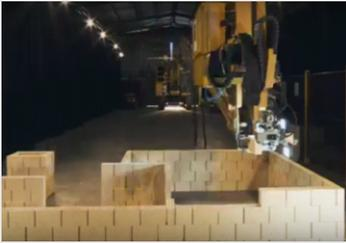
[그림 5-14] 벽돌을 쌓는 로봇, Fastbrick
