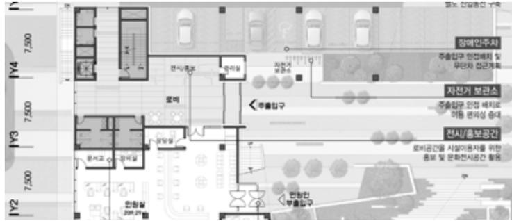
[그림 4-22] 청라3동 행정복지센터 1층 평면도 일부(설계공모 당선안)
